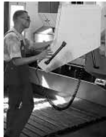
An diesem den Vorschriften entsprechenden Bearbeitungscenter darf nur im Normalbetrieb allein gearbeitet werden. Für die Behebung von Störungen, für den Werkzeugwechsel und für Instandhaltungsarbeiten muss eine Sicht- und Rufverbindung zu einer zweiten Person bestehen.
